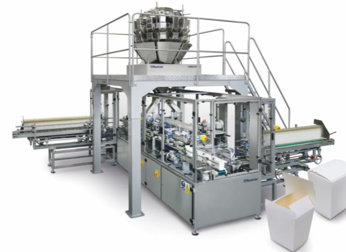
Vertical RKV-12S Z podwójnym systemem podawania kartonów
