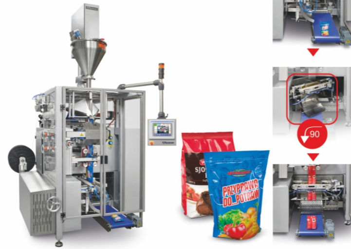
RM-32ACD Doypack wyposażony w obracane szczęki poziome oraz aplikator zippera
